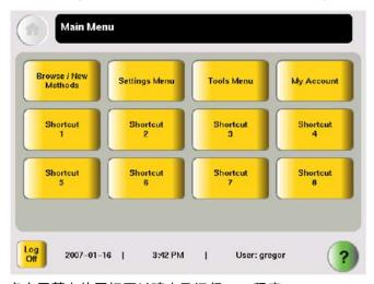
仪器使用触摸屏控制,点击屏幕上的图标可以建立及运行 PCR 程序。
