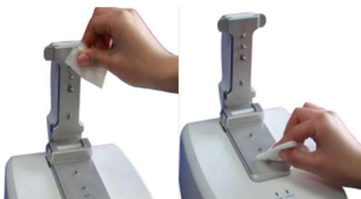
图 3.4 清除上下基座残留样品
