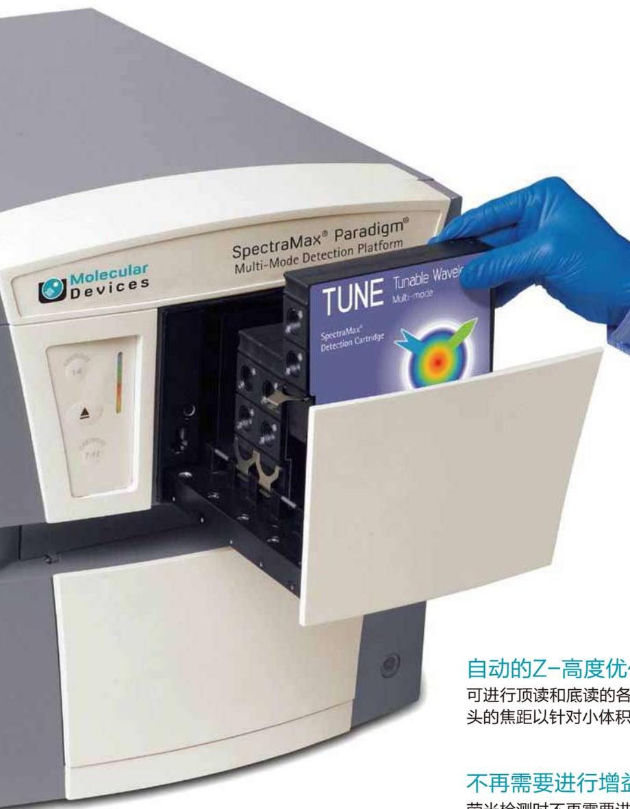
每个SpectraMax® Paradigm®检测卡盒都独立采用针对特殊应用的最优化的光源设计，或是采用高能LED、闪烁氙灯光源或高能激光。通过染料特异性的光学元件将高能激发光源聚焦于样品之上，从而达到高水平的检测灵敏度和性能。所有这些特殊的光学系统全部都集中在一个卡盒之内创建了一个最佳的多功能检测平台。
