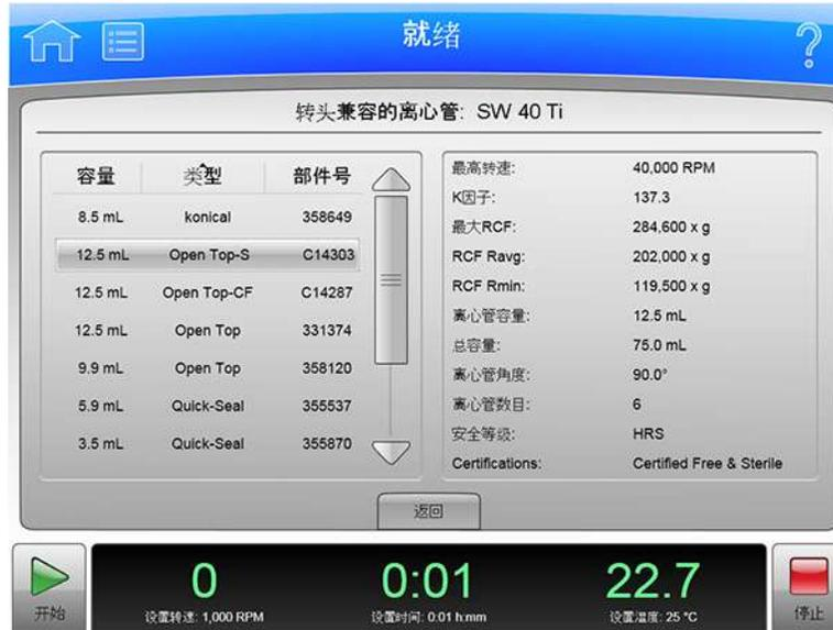
选择 **Rotor Catalog**（转头目录）页面上的 **Labware**（实验室器具）按钮时，会出现 **Compatible Tubes for Rotor**（转头的兼容离心管）页面，允许您检查所选转头的实验室器具。
