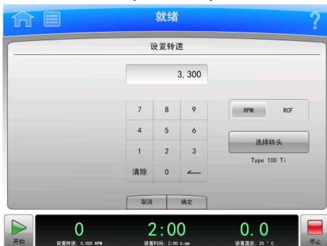
在 **Home**（主页）或脚注条上选择 **Set Speed**（设置转速）显示/按钮后，会出现 **Set Speed**（设置转速）页面，使您可以设置下一次运行的转速。做为一种替代方法，如果已经选择转头，可以使用 **RCF**（相对离心力场）为单位进行设置，而不是 **RPM**。
