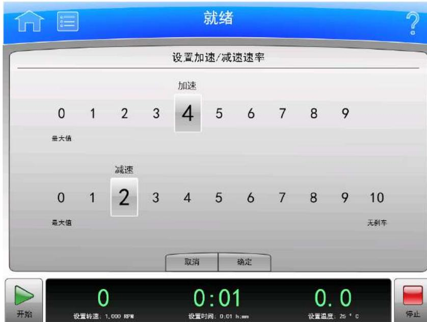
当您选择脚注条中的 **Accel/Decel**（加速/减速）按钮/显示时，会出现 **Set Acceleration/Deceleration Profiles**（设置加速/减速特征）页面，使您可以选择加速和减速特征。
