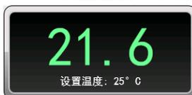
**Set Temp**（设置温度）显示/按钮将当前的转头温度显示为一个大的数字，还将当前温度设置以小的字符显示在底部。
