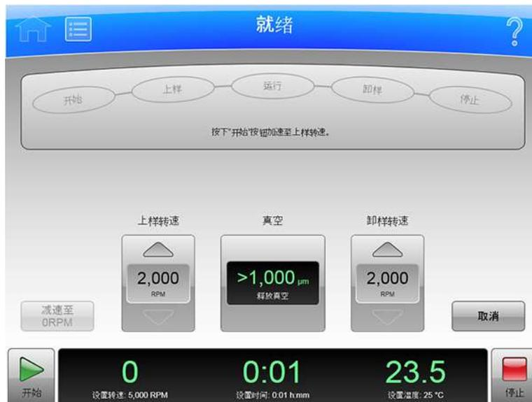
转头达到加载速度后，状态显示高亮显示正在加载，以便提示您已经进入下一个阶段。
