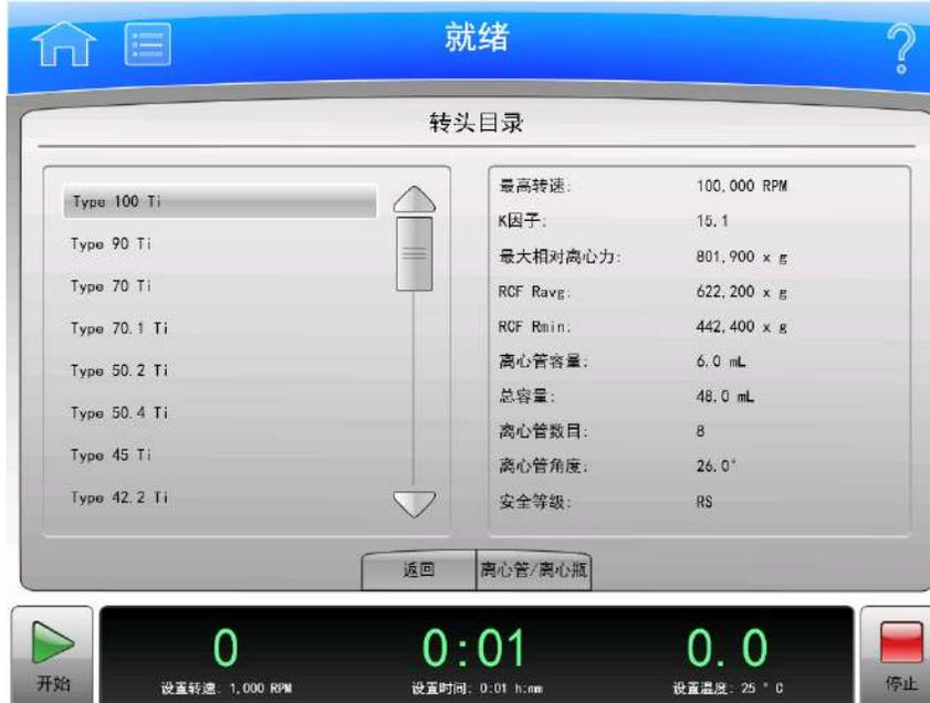
选择 **References**（参考资料）页面上的 **Rotor Catalog**（转头目录）按钮时，会出现 **Rotor Catalog**（转头目录）页面，允许您检查仪器所有可用转头的详细规格。
