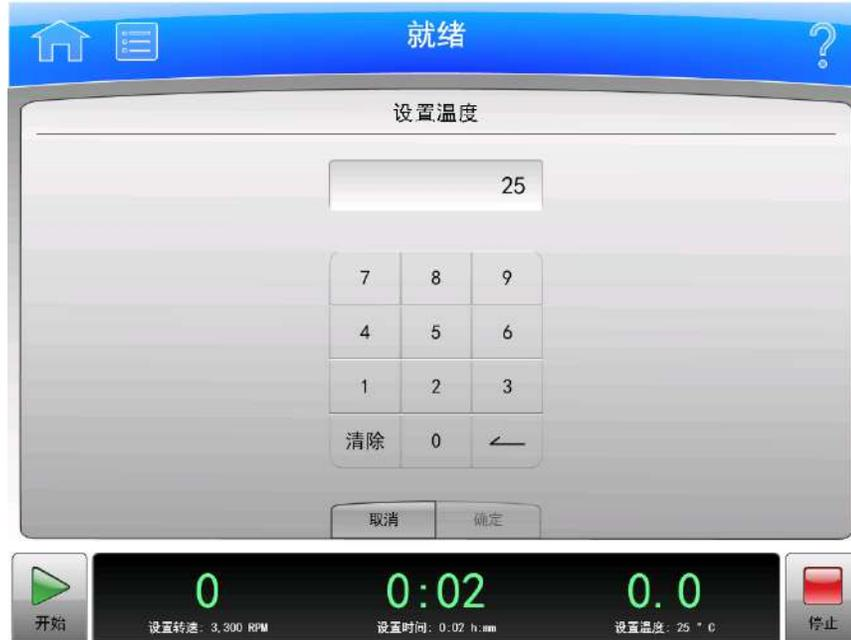
在 **Home**（主页）或脚注条上选择 **Set Temperature**（设置温度）按钮后，会出现 **Set Temperature**（设置温度）页面，使您可以设置下一次运行的温度。
