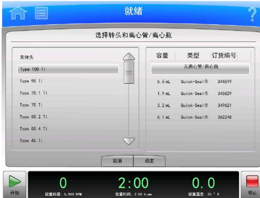
当选择 **Set Speed**（设置速度）页面或 **Set Speed Time**（设置转速时间）页面上的按钮时，会出现 **Select Rotor and Labware**（选择转头和实验室器具）页面，允许您选择一个转头用于下一次运行。
