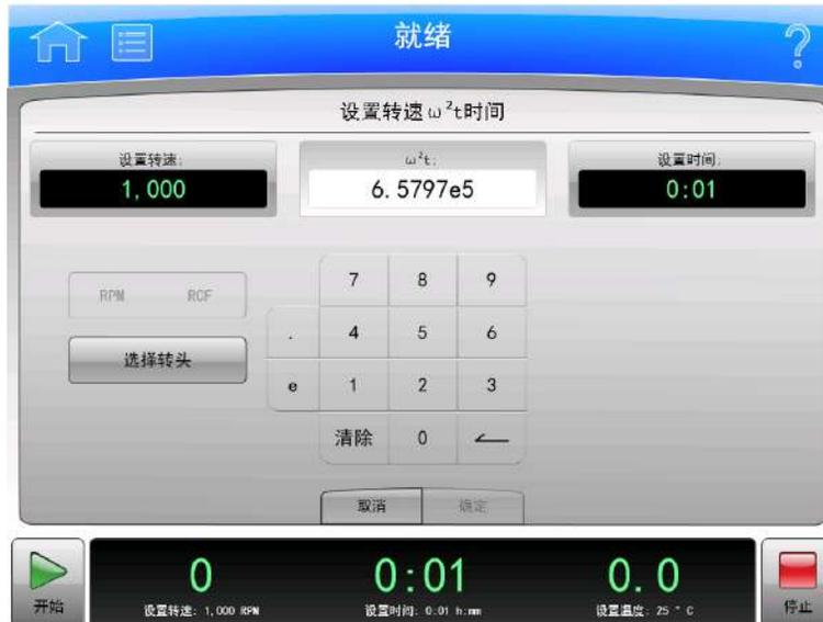
当  $\omega^2t$  模式被激活，并且在 **Home**（主页）或脚注条上选择了 **Set Speed**（设置转速）按钮或 **Set Time**（设置时间）按钮时，会出现 **Set Speed Time**（设置转速时间）页面。 $\omega^2t$  值根据您输入的时间和 RPM（或 RCF）值计算。将这些都放在同一页面上，可以使您设置下一次运行的数值，产生所需的  $\omega^2t$  值。
