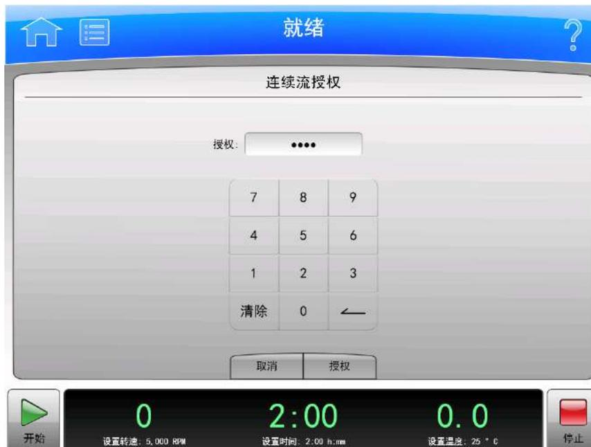
选择 **Menu**（主页）上的 **Continuous Flow Operation**（连续流操作）按钮时，会出现 **Continuous Flow Authorization**（连续流授权）页面，允许您在下一次运行中使用连续流模式。
