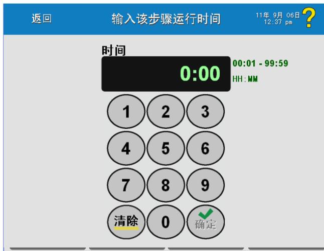
持续运行时间的可接受值显示在显示字段的右侧：从 00:01 至 99:59 HH:MM。
