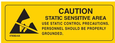
指示对静电放电 (ESD) 敏感的仪器区域。为了防止静电释放造成人身伤害，操作本仪器时，务必佩戴正确接地的腕带。有关正确接地的详细信息，请参阅 IEEE 标准 P1100。
