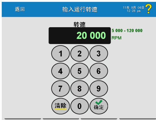
转速的可接受值显示在显示字段的右侧：从 5,000 到 120,000 RPM。
