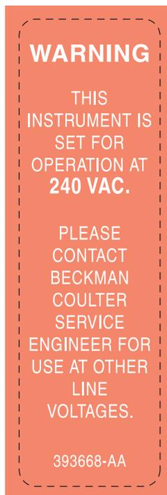
此符号表示仪器已经配置为使用 240 VAC 电压。如果使用其他线电压，请咨询 Beckman Coulter 服务工程师。
