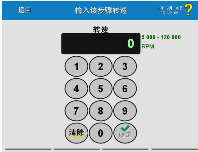
运行转速的可接受值显示在显示字段的右侧：从 5,000 到 120,000 RPM，取决于所选转子。
