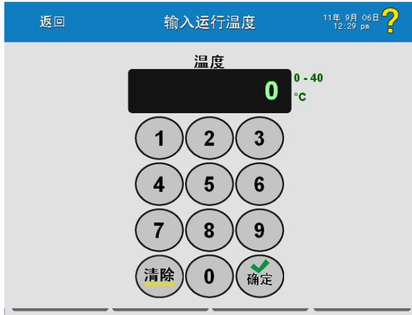
运行温度的可接受值显示在显示字段的右侧：0~40°C。
