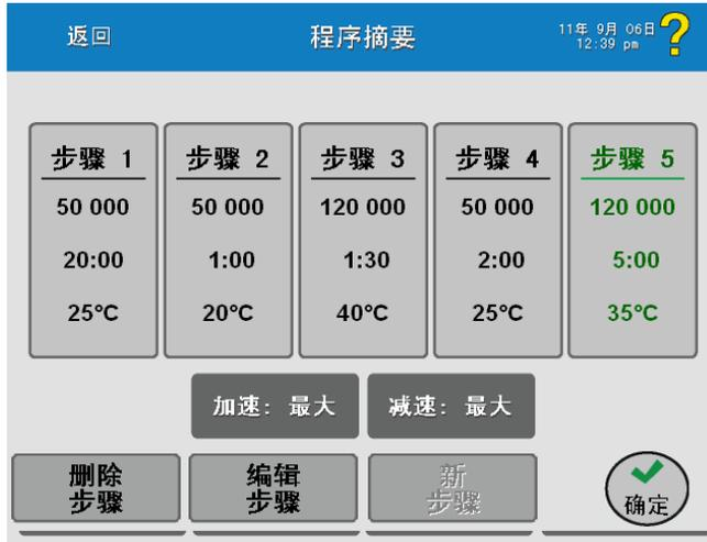
“加速”值适用于程序的第一步，“减速”值适用于程序的最后一步。在输入五个步骤后，**New Step**（新步骤）按钮将变灰。
