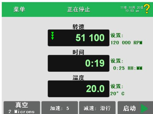
运行将在时间显示倒计时至零时自动停止，此时会发出声音。
