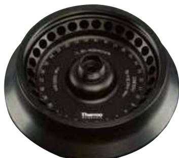
**Microliter 30 x 2 密封铝合金微量角转头, 45°, R<sub>max</sub> 100 mm**
